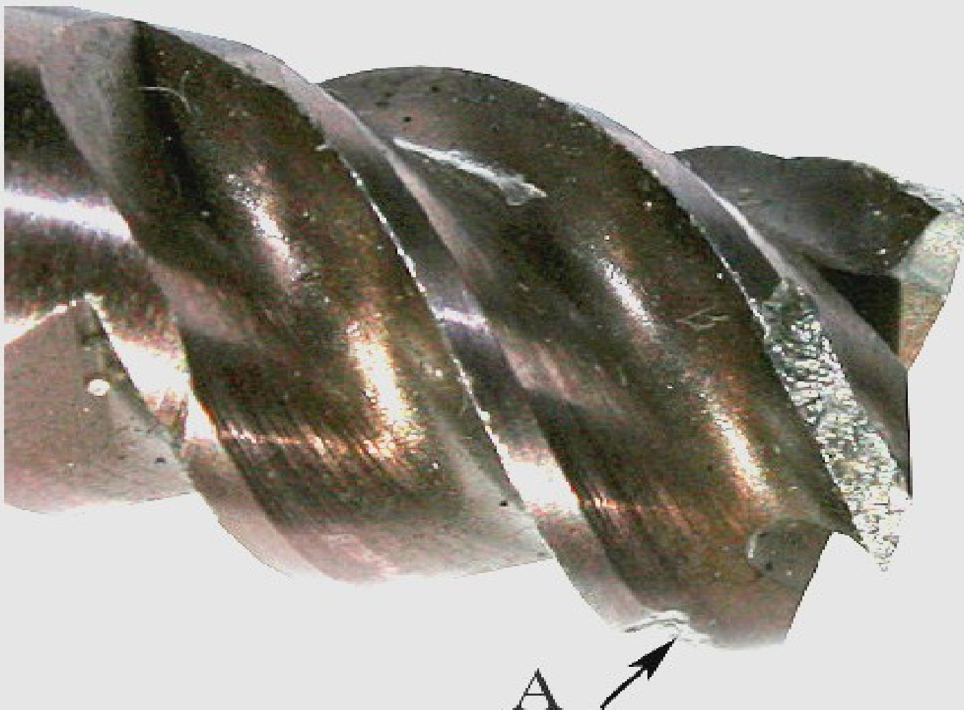
Zużycie frezu palcowego na krawędzi przejściowej
