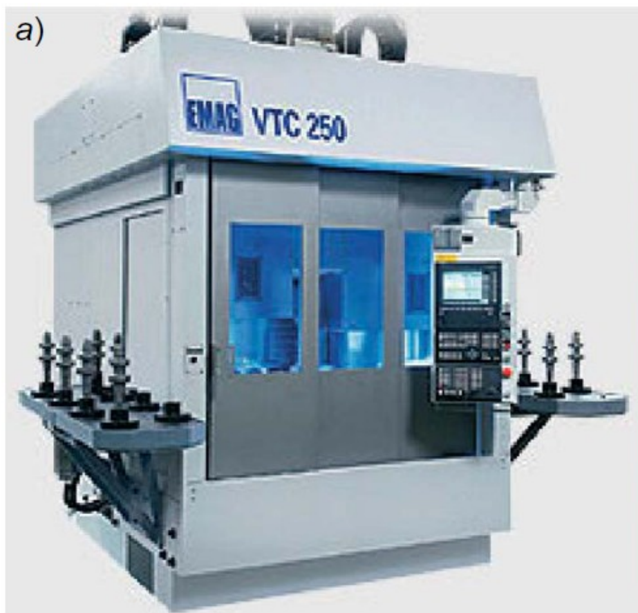
Tokarka pionowa do obróbki wałków VTC 250 firmy EMAG: a) widok, b) wymiana przedmiotów
